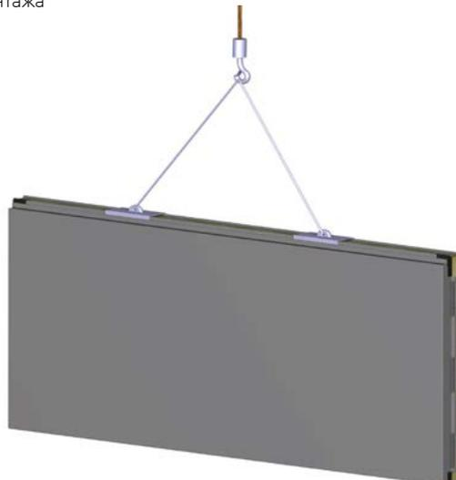
Для одного подъема потребуются два захватных устройства, которые поставляются вместе с фасадными элементами Qbiss One B по предварительному заказу (см. рис. 3.5). Инструкция по использованию захватного устройства прилагается.
